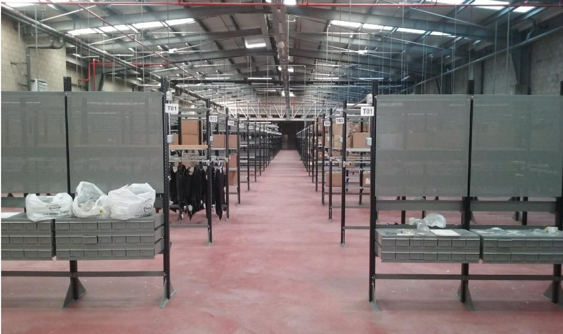
Nuestro exclusivo sistema de montantes con ranuras permite que las bandejas sean versátiles, pudiendo colocarlas o intercambiarlas en cualquier lugar del montaje sin necesidad de emplear tornillos para su ubicación. A diferencia de otras, las bandejas Euroservicio se componen de una sola pieza, pudiendo soportar grandes cargas;
