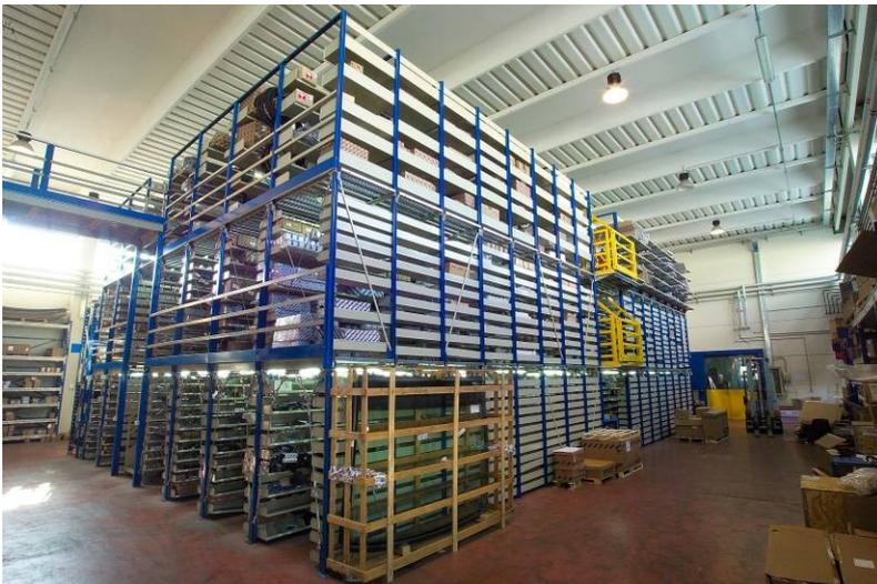
A diferencia de otros, el sistema Euroservicio permite que su almacén de estanterías pueda elevarse a dos o tres niveles de piso sobre la misma estructura de estanterías, ofreciendo una imagen totalmente homogénea y dotando a su almacén de una estética agradable. De esta manera aprovechamos al máximo el espacio.
