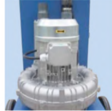
Motor instalado en Sistema de reducción de vibración
